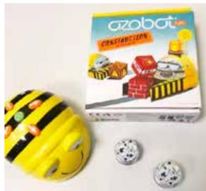
Der BeeBot-Roboter ist ein kleiner, gelb-schwarz-gestreifter Roboter, der ganz ohne zusätzliche Geräte direkt über Pfeiltasten am Roboter selbst gesteuert wird. Da sich am BeeBot-Roboter insgesamt nur sieben Tasten befinden, ist die Steuerung auch schon für Kinder ab 4 Jahren intuitiv und leicht verständlich.
